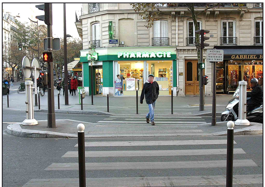
La présence d'un îlot-refuge durant une longue traversée de chaussée constitue un élément de sécurité très apprécié des usagers ayant des difficultés de déplacement, comme les personnes âgées.
